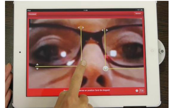
9 – Нажмите «**ДАЛЕЕ**» для продолжения измерений. Результаты измерения монокулярного межзрачкового расстояния для близи (PD) и дистанция до текста доступны на экране.
