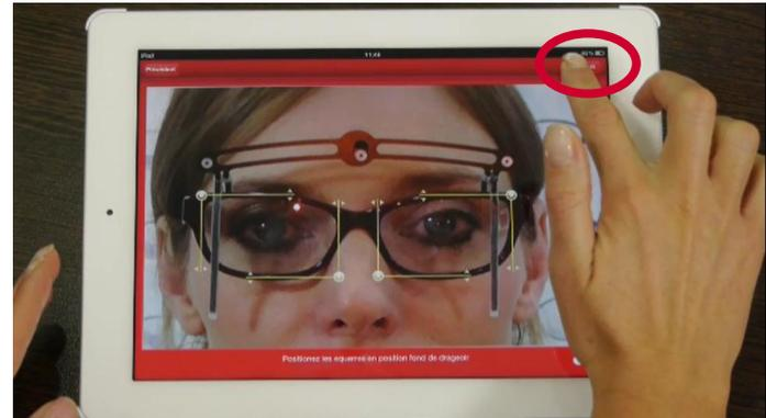
12 – Результаты измерений монокулярного межзрачкового расстояния для дали (PD) и установочная высота (H) доступны на экране.
